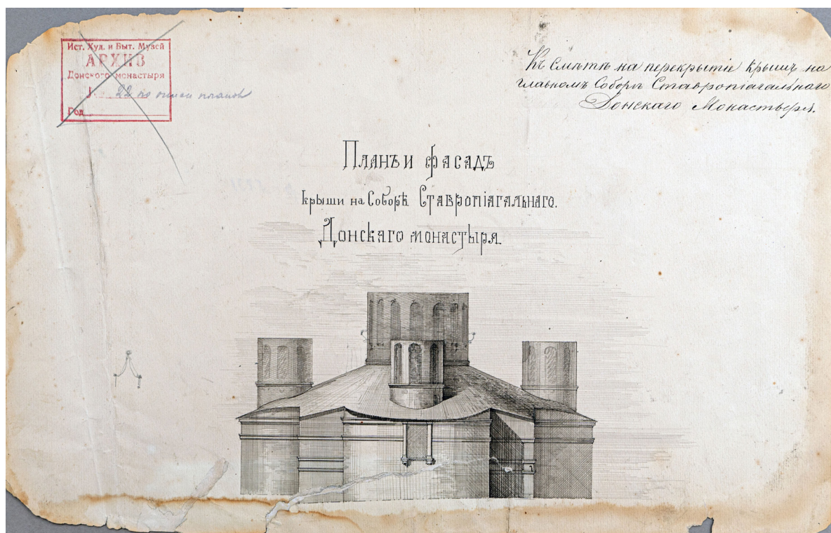
Иллюстрация 3 — План и фасад крыши на соборе ставропигиального Донского монастыря.
