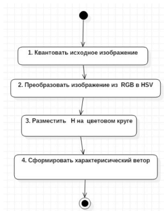
Рисунок 2 – Этапы индексации цветовых контрастов Figure 2 – Phases of color contrasts indexing
